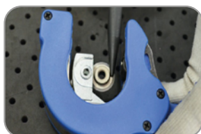
2. Retire a lâmina antiga com um alicate
