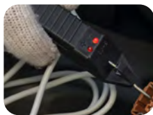
A luz acende quando detecta tensão
