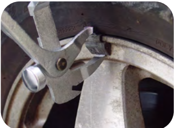
Fixa e remove os pesos de balanceamento
