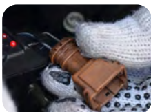
A luz de LED indica a polaridade positiva (+) ou negativa (-)
