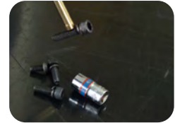
Ponta magnética: 0,5 Kg de capacidade de carga
