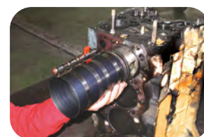
A compressão dos anéis nas ranhuras facilita a instalação e a remoção do pistão
