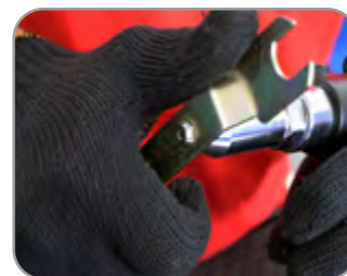
Pontas fixadoras de 2.4, 3.2, 4 e 4.8 mm
