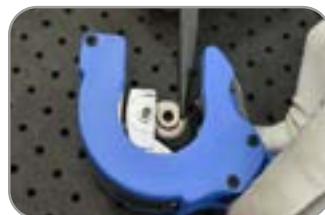
2. Retire a lâmina antiga com um alicate
