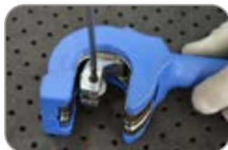
1. Desparafuse a lâmina com uma chave de fenda cruzada (Phillips)
