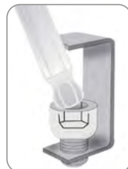
Perfil abaulado com ângulo de acesso de até 25° com rotação completa de 360°
