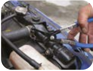
Ideal para instalar e remover abraçadeiras de mangueiras do radiador
