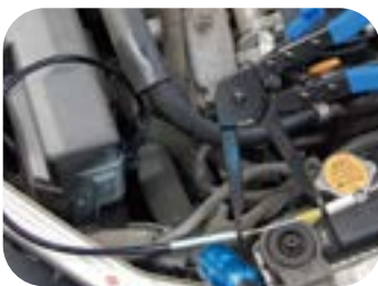
A haste flexível facilita a instalação e a remoção de abraçadeiras em locais de difícil acesso
