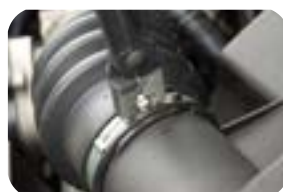
Remover e instalar abraçadeiras Clic-C e Clic-R
