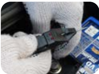
Mecanismo deslizante de agulha
