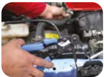
A haste flexível facilita a instalação e a remoção de abraçadeiras em locais de difícil acesso
