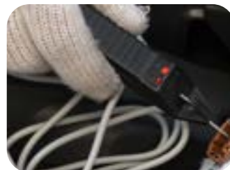
A luz acende quando detecta tensão
