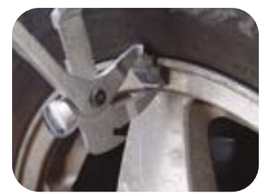
Fixa e remove os pesos de balanceamento
