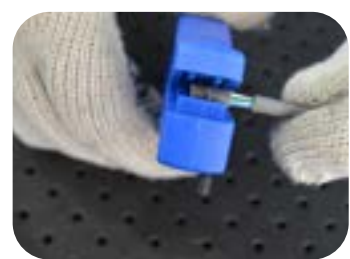
Ideal para desencapar cabos UTP/ STP 2,6-8mm
