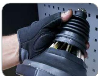
Posicione a nova coifa sobre as garras do instalador pneumático, certificando-se que a mesma não sairá de posição quando as garras forem acionadas.
