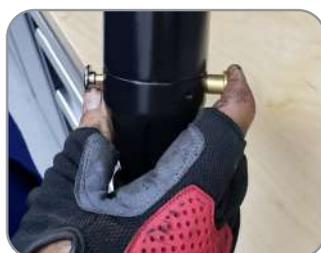
Pressione o gatilho de acionamento. As garras do instalador pneumático abrirão até o diâmetro máximo de 110 mm, expandindo a coifa.
