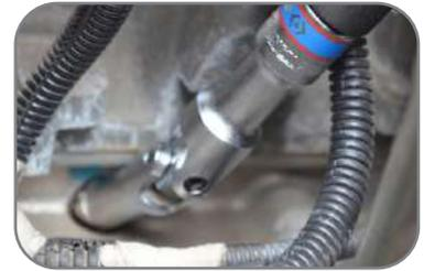
Garante maior firmeza durante a instalação e remoção de velas em motores diesel
