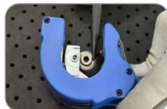
2. Retire a lâmina antiga com um alicate
