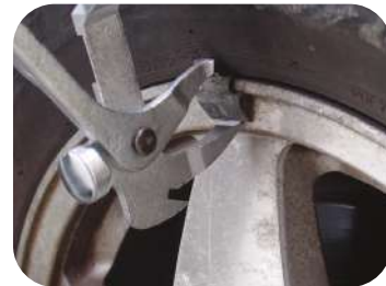
Fixa e remove os pesos de balanceamento
