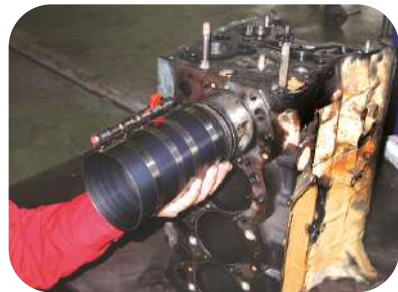
A compressão dos anéis nas ranhuras facilita a instalação e a remoção do pistão
