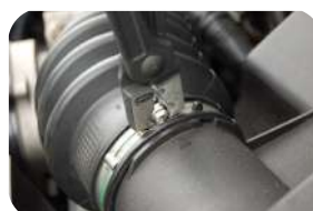
Remover e instalar abraçadeiras Clic-C e Clic-R
