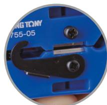
Lâmina central esquerda: Desencapa fios pequenos e cabos chatos RJ
