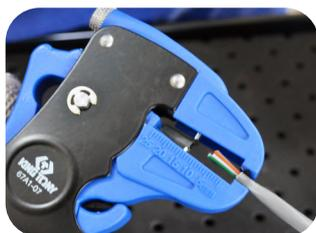
Ajuste de comprimento do corte
