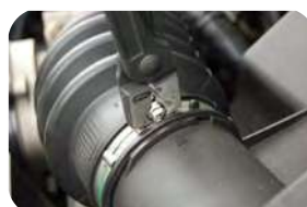
Remover e instalar abraçadeiras Clic-C e Clic-R
