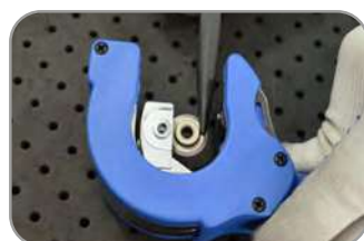
2. Retire a lâmina antiga com um alicate
