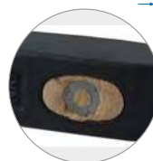
Fixação por cunha de metal
