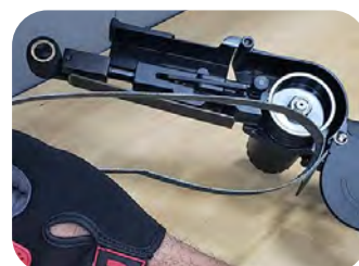
Coloque a cinta, feche o compartimento da polia e em seguida destrave o embolo
