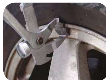
Fixa e remove os pesos de balanceamento
