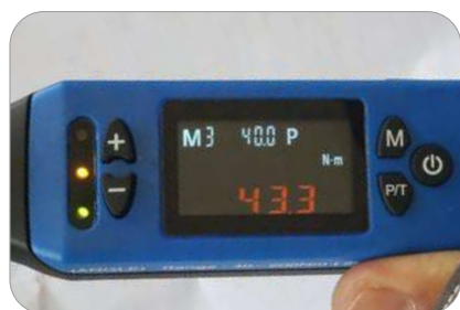
Lâmpadas de LED indicam o fim da operação; Luz piscante 80% do torque, luz estática 100% torque atingido.
