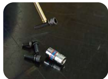
Ponta magnética: 0,5 Kg de capacidade
