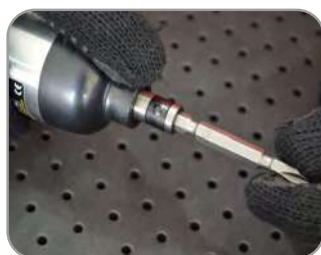
Encaixe com anel de retenção e esfera de aço para power bit
