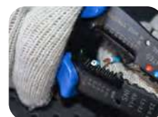
Desencapa fios de 0,75 mm 2 a 5,6 mm 2 e AWG com bitolas de 20-10
