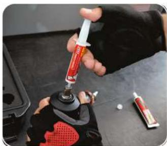
Acompanha kit para fácil lubrificação para recuperação da força e manutenção de baixo ruído do mecanismo.
